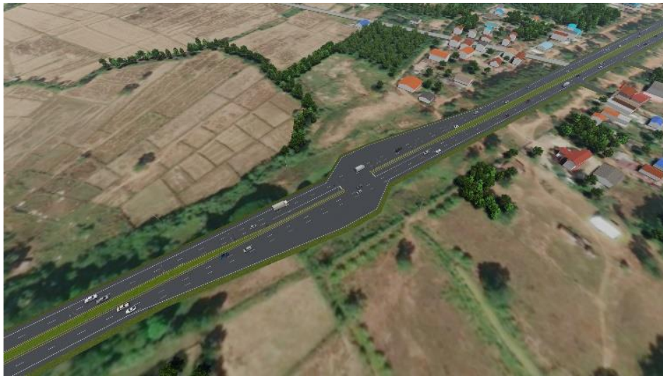
รูปที่ 6-18 รูปแบบจุดกลับรถแบบที่ 2 แบบไม่มีทางเท้า
