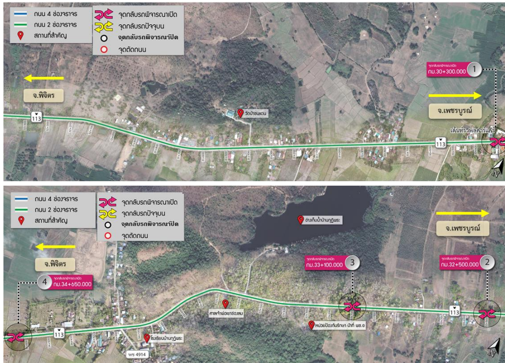
รูปที่ 6-11 จุดกลับรถใหม่ในกรณีช่วงที่จะขยาย 4 ช่องจราจร ช่วง กม.30+100 ถึง กม.35+357
