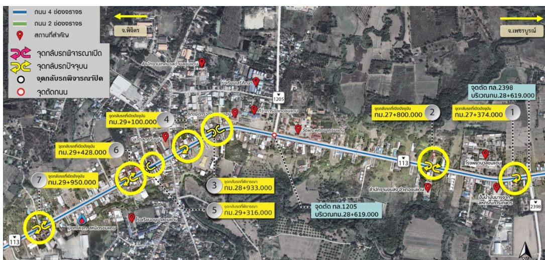
รูปที่ 6-10 จุดกลับรถ 4 ช่องจราจรเดิม กม.27+000 ถึง กม.30+100
