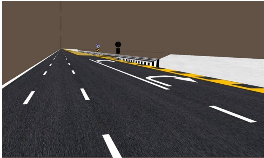
รูปที่ 6-16 รูปแบบจุดกลับรถแบบที่ 1
