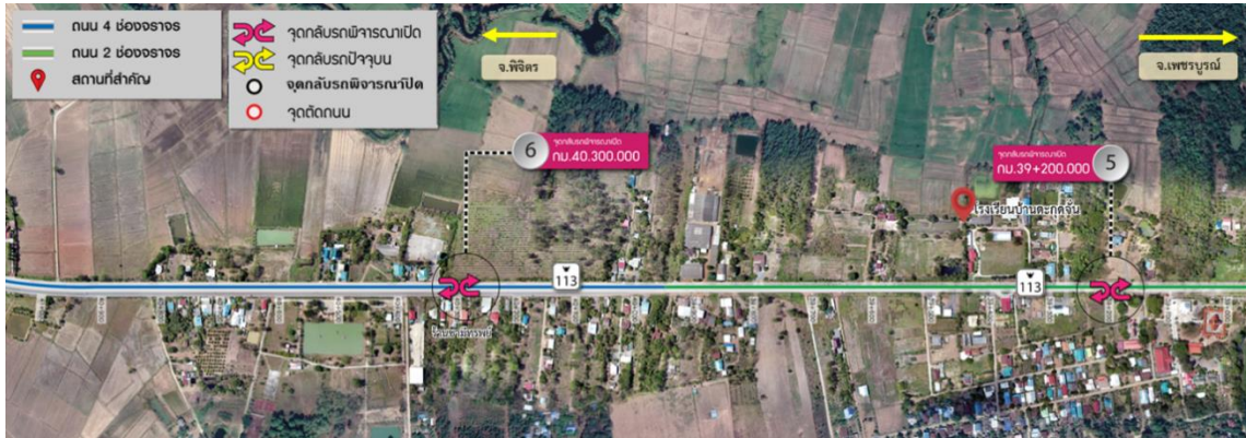
รูปที่ 6-13 จุดกลับรถใหม่ในกรณีช่วงที่จะขยาย 4 ช่องจราจร ช่วง กม.37+594 ถึง กม.40+000
