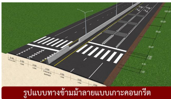
รูปที่ 6-20 รูปแบบทางข้ามทางม้าลายแบบเบื้องต้นเกาะคอนกรีตและแบบเกาะยก
