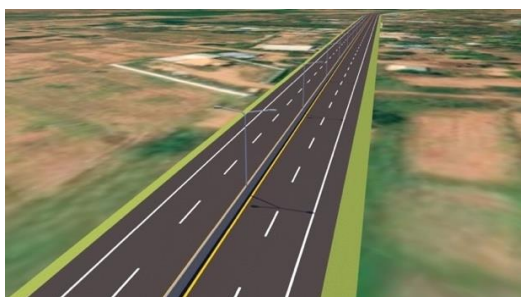
รูปที่ 5-17 รายละเอียดการวางไฟฟ้าส่องสว่าง บริเวณพื้นที่โครงการ (นอกเขตพื้นที่ชุมชน)
